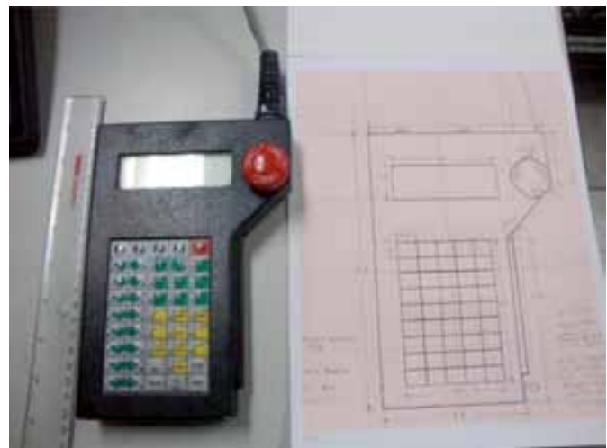
Figura 6. Teach pendant para el Robot F3.
